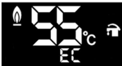
**Figure 17. DHW Comfort Mode Screen View**
