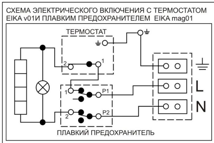
Нагревательные блоки 6,6 кВт - предназначенные только для подключения к фиксированной линии!
